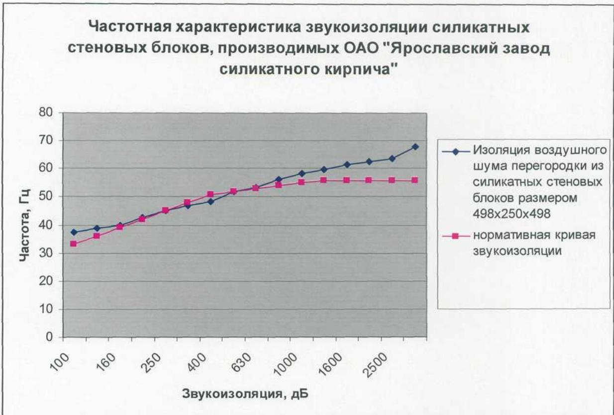
Рис. 1. Частотные характеристики.
